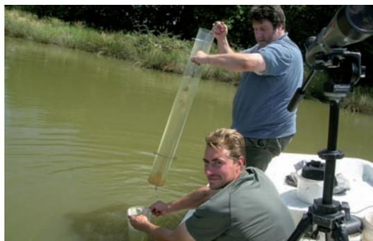
Prélèvement d'eau par le personnel de la Fondation Pierre Vérots sur l'étang Boufflers pour inventaire du phytoplancton et analyse physico-chimique de l'eau. Prélèvements similaires effectués sur le Grand-Birieux par L'ISARA.
